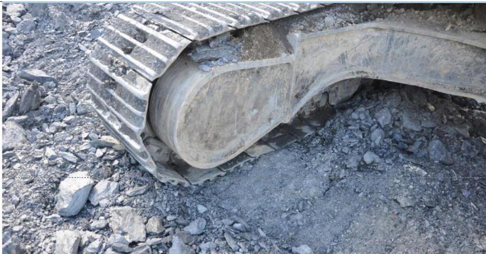
Figur 42: Skiferen har lav styrke. Den tåler ikke friksjonskrefter. Når den er fragmentert (sprengstein) vil den forvitre til finstoff i kontakt med fuktighet. Ved mekanisk påkjenning som vist i bildet knuses skiferen ned til en leiraktig suppe. Dette kan bl.a registreres ved at det er som å gå på en "gummimatte" på utsprengte masser. NGI (2013)
