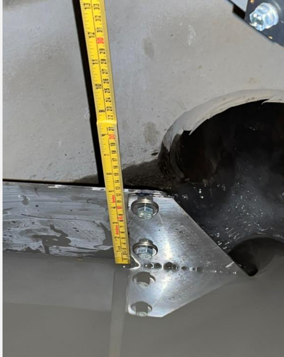
NGI | V-overløp for måling av vannstrøm
