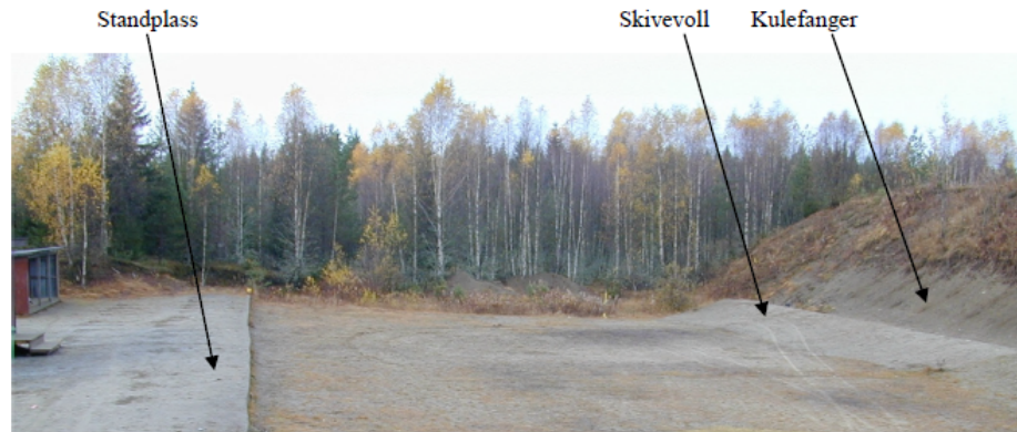
Figur 3.1 Basisskytebane med standplass, skivevoll, og kulefanger i Sessvollmoen skyte- og øvingsfelt. Foto: FFI
