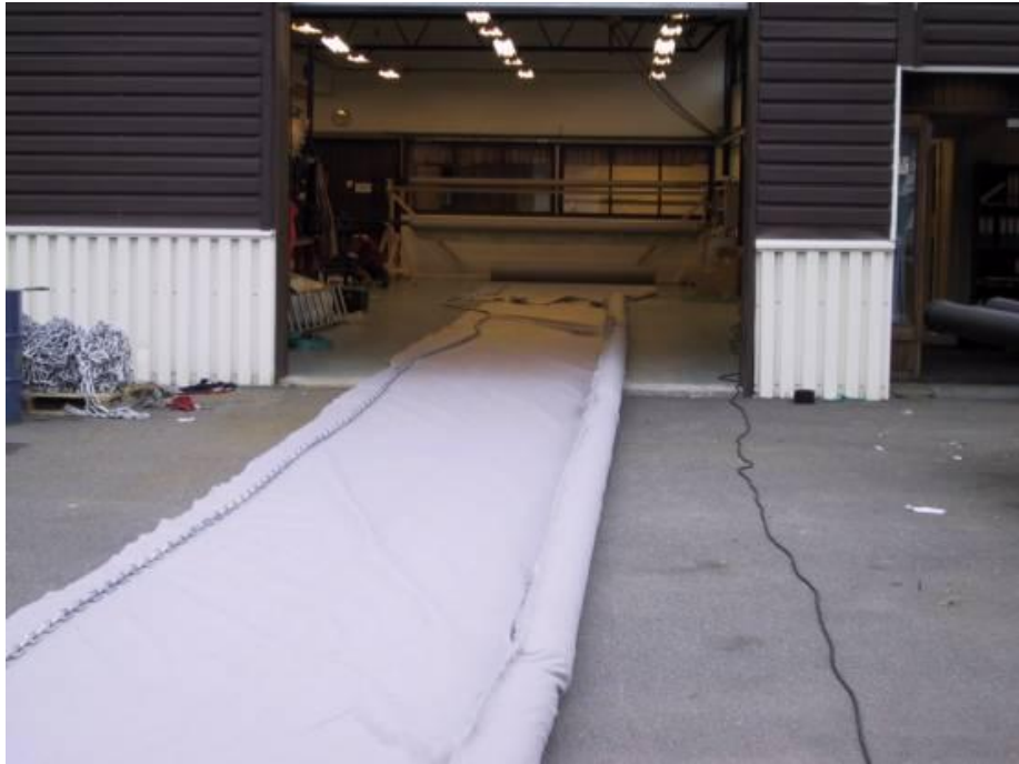
Siltgardin under produksjon i pilotprosjektet i Sandefjord. Flytere er sydd inn på toppen av gardinen (til høyre) og kjetting som skal fungere som lodd skal sys inn (til venstre).
