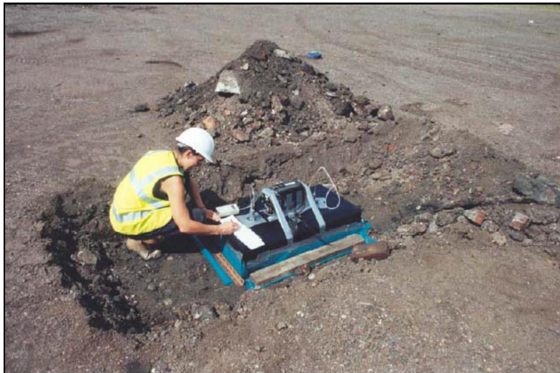
Bruk av fluksboks til emisjonsmåling på deponioverflate. Kilde: National Housebuilding Council (NHBC), 2007. Guidance on evaluation of development proposals on sites where methane and carbon dioxide are present. Rev.4. Datert mars 2007
