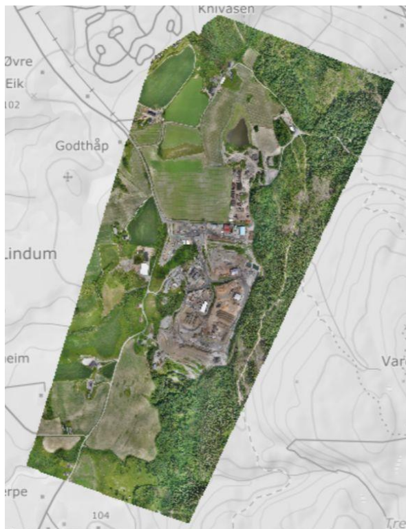
Drammen 45 hektar Deponigass til fjernvarme 80 Nm 3 /t (tidligere 1500 Nm 3 /t) 200 brønner
